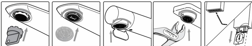
Coloque la herramienta correspondiente según el tipo de aireador y remuévalo del pico. Lávelo bajo un chorro de agua. Si está tapado colóquelo en un vaso de vinagre durante la noche. Al día siguiente vuelva a armarlo.
