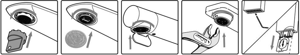
Coloque la herramienta correspondiente según el tipo de aireador y remuévalo del pico. Lávelo bajo un chorro de agua. Si esta tapado colóquelo en un vaso de vinagre durante la noche. Al día siguiente vuelva a armarlo.
