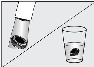
Lave el aireador bajo un chorro de agua. Si está tapado, colóquelo en un vaso con vinagre durante la noche. *Clean the aerator under a water flow. If there is any sediment, place it in a glass containing vinegar for the night.*
