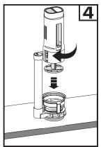
Ajustar nuevamente la válvula de descarga sobre el soporte aplicando presión hacia abajo y girándola hasta que se enganche.
