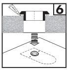
Colocar masilla plástica en el aro de acople y posicionar nuevamente el inodoro sobre el desagüe.
