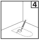
Marcar en el piso los orificios para las fijaciones del inodoro al piso usando de referencia las medidas tomada en el paso 3.
