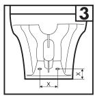
Medir la distancia entre ejes de los orificios y la profundidad de los mismos para la fijación al suelo.
