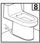
Sellar la unión entre el inodoro y el piso con un cordón de silicona. No utilizar cemento para fijar el inodoro, puede generar fisuras.
