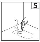
Perforar en las marcas realizadas y colocar los tarugos (C) y los pernos de fijación.
