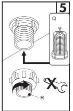
Colocar el filtro opcional (Q) dentro de la tubería de entrada de agua y a justar el adaptador para la conexión del flexible.
