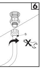
Conectar el flexible (S) de la llave angular a la válvula de llenado del depósito.
