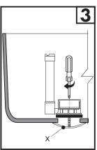
Ajustar el tornillo para fijar el anclaje (X) a la base del depósito.
