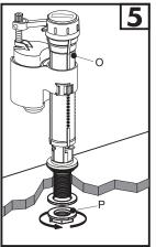
Colocar la válvula de llenado (O) en el orificio de entrada de agua del depósito y ajustar con la tuerca (P)
