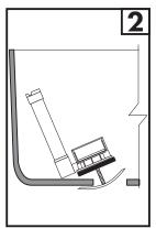
Introducir en el orificio de descarga, como lo muestra la figura.
