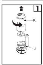
Retirar el soporte (J) de la válvula de descarga (K). Para extraerla aplique presión hacia abajo y gírela hasta que se desenganche.
