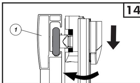
Vista seccionada del perfil superior/Section view upper rail
