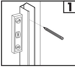
Nivelar el perfil 2 y marcar los agujeros para la fijación de la cabina.
