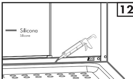
Aplicar silicona en todos los contornos en contacto con las paredes y el receptáculo.
