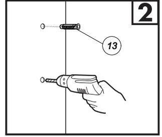
Realizar la perforación y colocar los tarugos.
