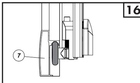
Vista seccionada del perfil inferior/Section view lower rail
