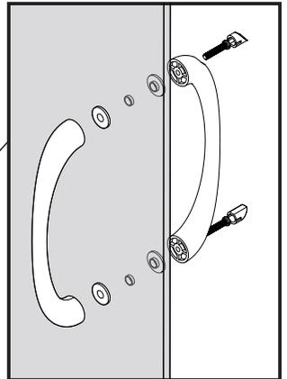
Armar manija con los tornillos hacia el interior de la cabina.
