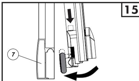
Vista seccionada del perfil inferior/Section view lower rail
