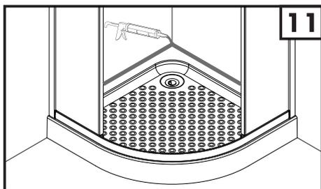
Aplicar la silicona en el contorno interno del receptáculo, sellando las juntas con la pared.
