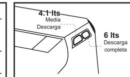
Las descargas se pueden accionar manualmente presionando los botones laterales según su necesidad.
